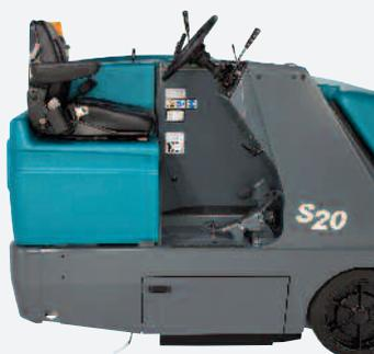
Le spacieux compartiment pour l'opérateur comprend un siège réglable, une pédale de propulsion et une colonne de direction ajustables pour un plus grand confort d'utilisation. Les caractéristiques de conception comprennent une excellente visibilité, une vue de la brosse latérale, un balayage avec tous les leviers vers l'avant, un témoin avertisseur de frein de stationnement.
